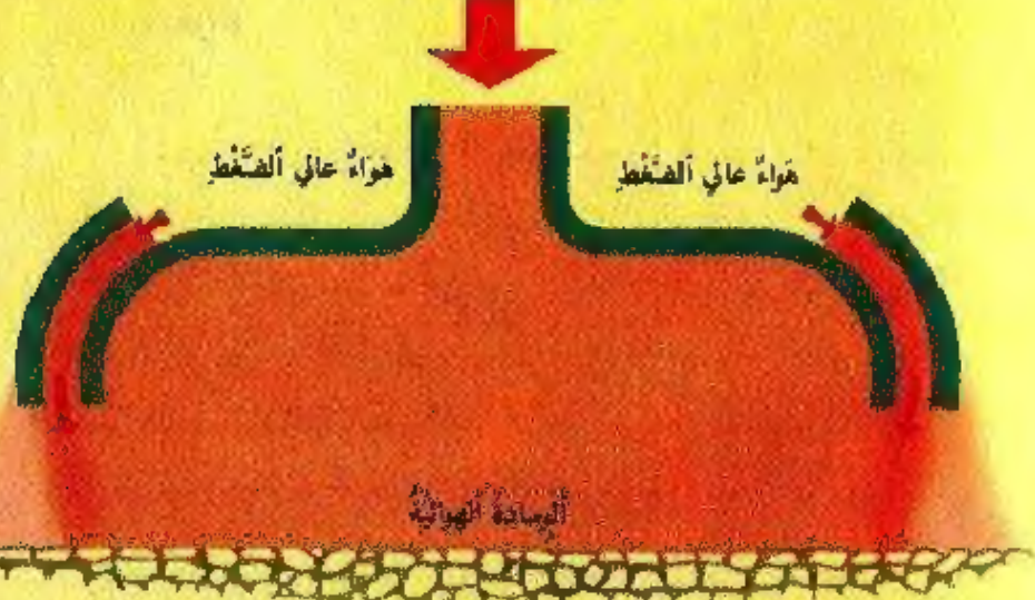
نموذج أولي لحجرة ملاءة مزودة بمنافث هواء عالي الضغط لحفظ توازن الحوامية
